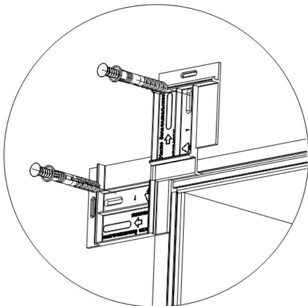
Шаг 3. Закрепить защелки в углах так, чтобы они соприкасались для обеспечения возможности крепления крышек угловых.
