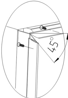
Шаг 1. Замерить, подрезать под углом 45° и установить стартовые профили. Шаг между саморезами 300-500 мм.
